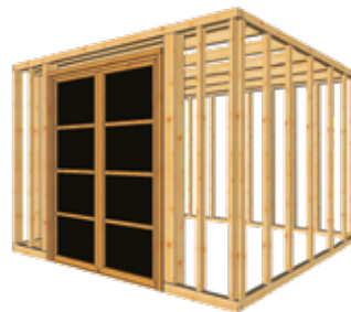
Système constructif avec ossature 45x70w
